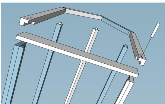
COLOCAR LA ESTRUCTURA DE PIE PARA ATORNILLAR LA BASE DE LA CAMA
