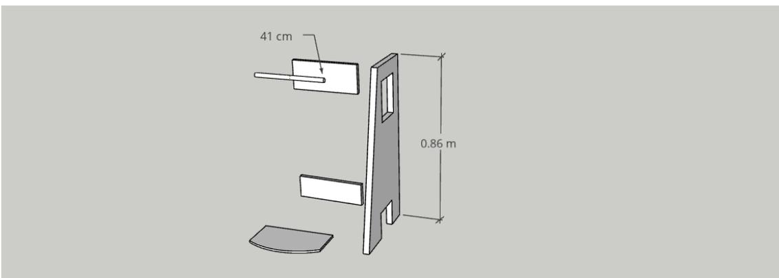
FIJAR LAS PIEZAS DE 39 CM SOBRE UNO DE LOS LATERALES CON LOS TORNILLOS DE 60 MM PROPORCIONADOS PARA POSTERIORMENTE ENCAJAR EL OTRO LATERAL
